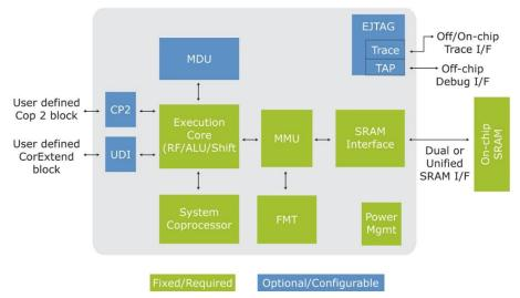
MIPS32<sup>®</sup> M4K<sup>®</sup> Core Block Diagram
